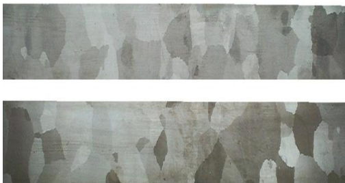
Рисунок 5 – Макроструктура стали после ВТО. Текстурное состояние готовой стали представлено
