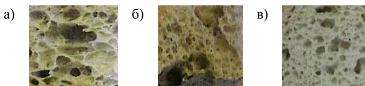
Рисунок 1 – Структура образцов пеностекла, полученного из сырья разной степени крупности, мкм:
