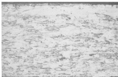
Рисунок 1 – Микроструктура стали в состоянии после холодной прокатки (×250)
