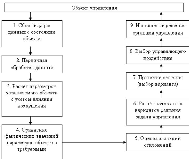
Рисунок 1 – Упрощённая схема переработки информации в АСУ
