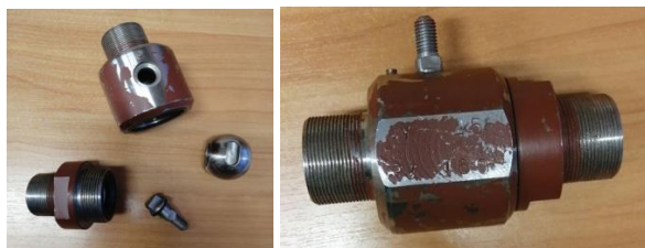
Рисунок 2 – Детали и общий вид крана шарового
