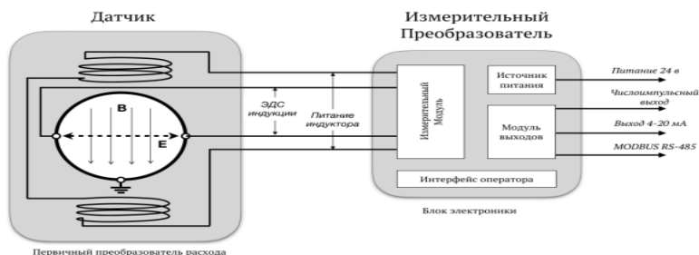
Рисунок 3 – Структурная схема расходомера
