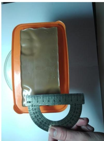
Рисунок 3 – Измерение пучностей стоячей волны на поверхности молочного шоколада
