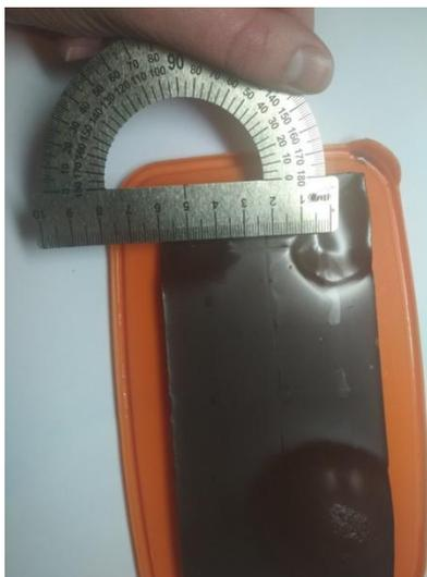
Рисунок 2 – Измерение пучностей стоячей волны на поверхности темного шоколада
