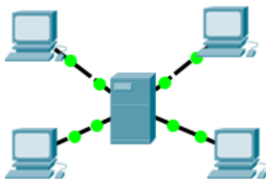
Рисунок 3 – схема соединений при групповой видеосвязи с наличием медиасервера
