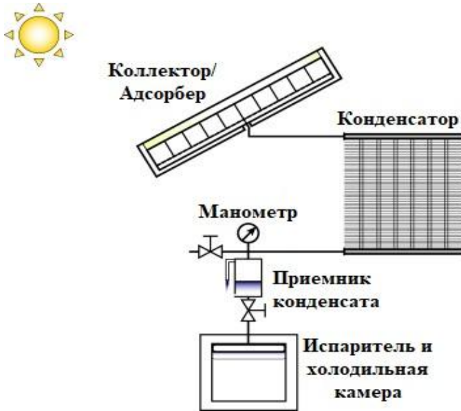
Рисунок 2 – Абсорбционная система охлаждения, работающий с силикагелем и водой
