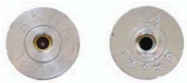
Рисунок 5 – Следы контактного узла на дне стреляных гильз патронов разных производителей
