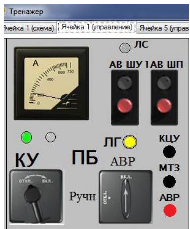
Рисунок 2 – Ячейка №1 рабочее положение вводного выключателя и Авр
