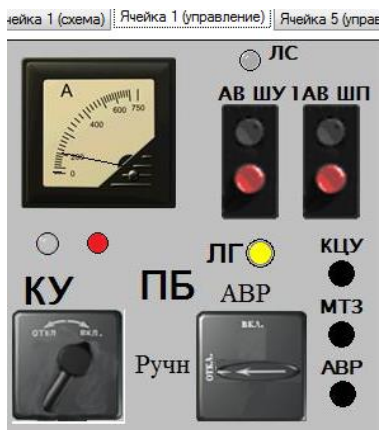
Рисунок 3 – Выполнили действие вывод из работы АВР
