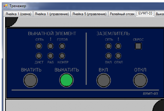
Рисунок 5 – перевод переключателя в положение выкатить
