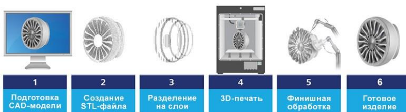
Рисунок 5 – Технологическая последовательность изготовления локальных объектов
