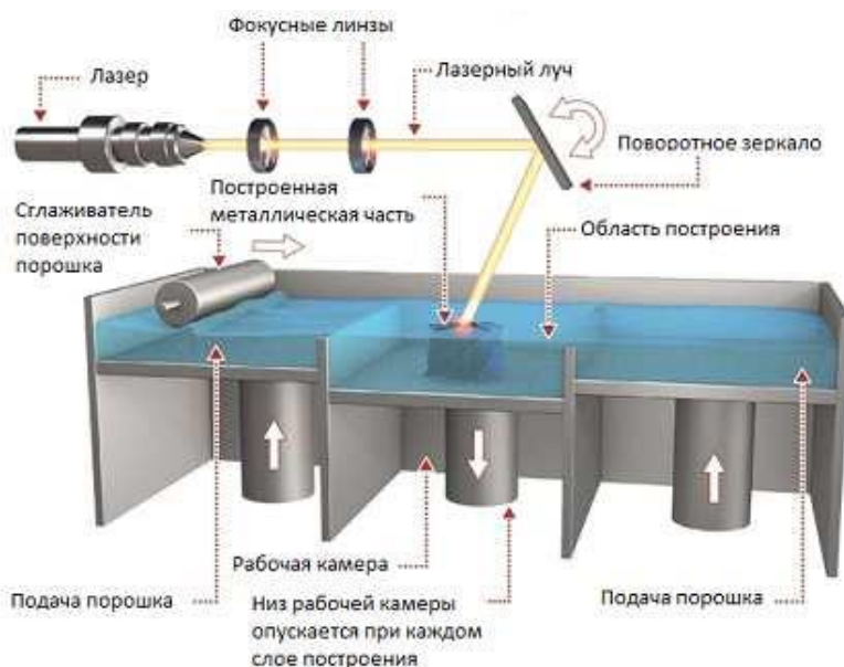
Рисунок 6 – Принципиальная схема построения формы методом SLM
