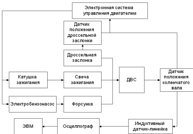
Рисунок 1 – Структурная схема стенда для проведения испытаний ДВС
