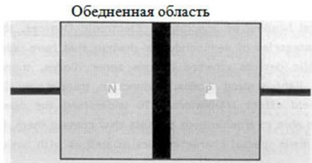
Рисунок 2 – Обедненная область на схеме p-n перехода
