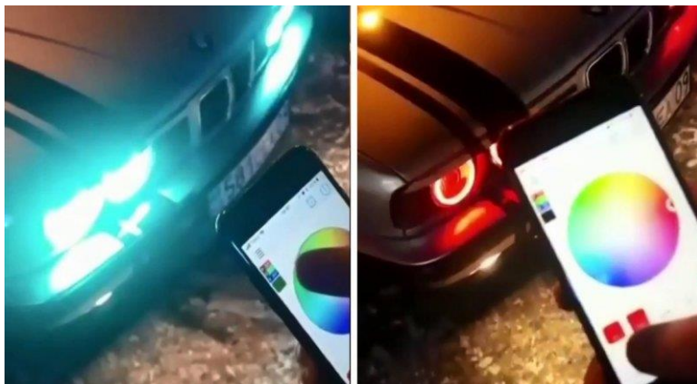
Рисунок 1 – Пример установки на ТС фар ближнего света с изменяемым цветом
