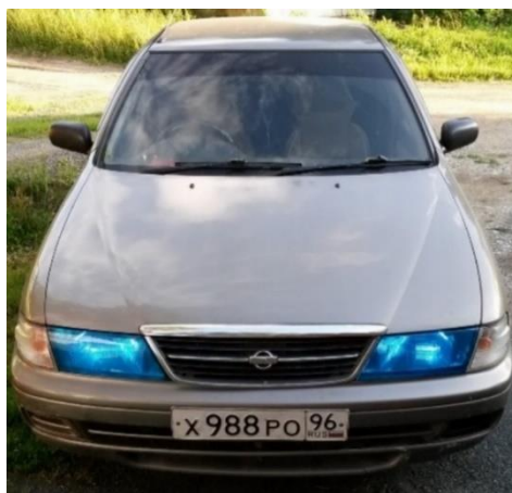
Рисунок 2 – Пример использование цвета ВСП не соответствующему ЕЭК ООН №48
