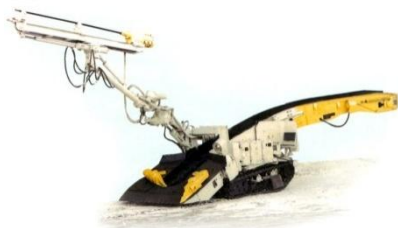
Рисунок 2 – Гусеничная машина с парными нагребающими лапами
