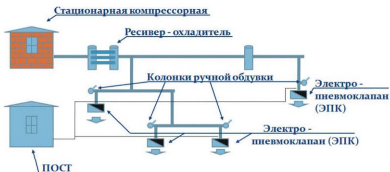
Рисунок 1 – Система автоматической пневмоочистки стрелочных переводов
