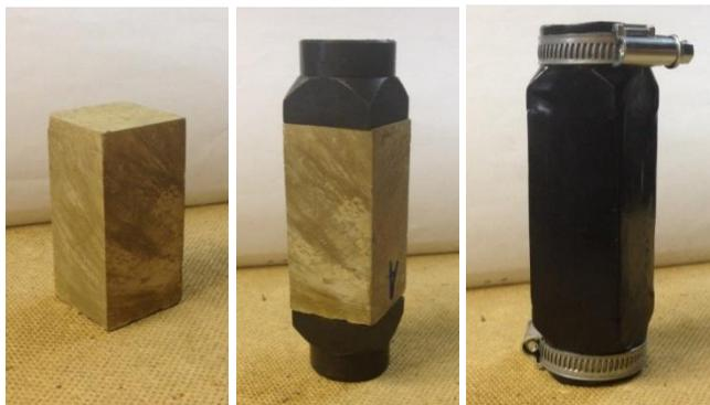
Рисунок 1 – Этапы подготовки образца для испытаний в камере объемного нагружения
