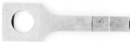
Рисунок 2 – Образец после нагружения знакопеременным изгибом (частота испытаний 18кГц, вторая форма собственных колебаний)
