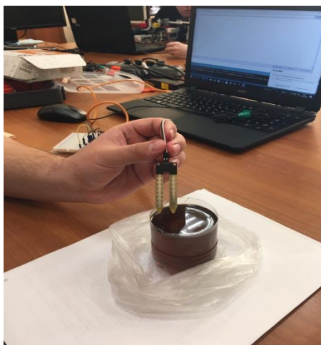
Рисунок 2 – Проведение эксперимента по экспресс-диагностики моторного масла
