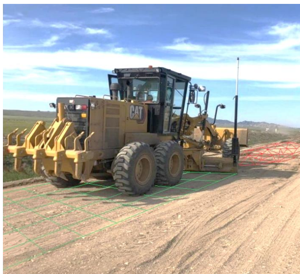
Рисунок 2 – Работа автогрейдера с системой распознавания образов
