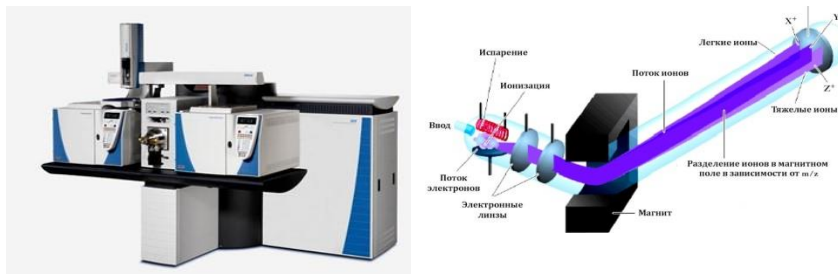
Рисунок 1 – Масс-спектрометр и принцип его действия
