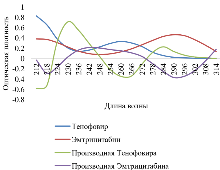
Рисунок 3 – УФ-спектры поглощения тенофовира и эмтрицитабина в 0,1 М растворе хлористоводородной кислоты и графики второй производной спектров при шаге 6 нм.
