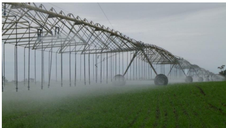
Рисунок 1 – Дождевальная система для орошения полей (PIVOT)
