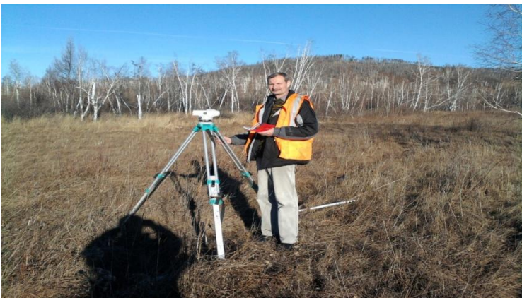
Рисунок 5 – Нивелирование трассы нагорного канала
