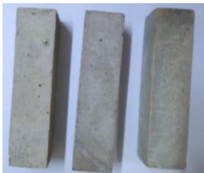
Рисунок 2 – Образец серного бетона
