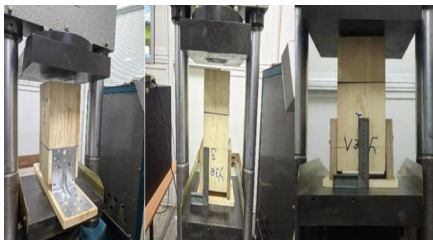
Рисунок 2: А) сквозные стальные стержни из арматуры А-240 – накладки стальные; Б) сквозные стальные стержни из арматуры А-240 –накладки фанерные (ФБС); В) сквозные стержни из стеклопластиковой арматуры АСП-10 – накладки фанерные.
