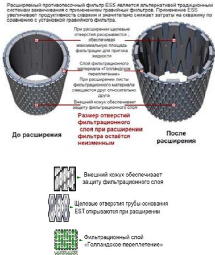
Рисунок 3 – Технология расширяющихся фильтров ESS компании «Weatherford»
