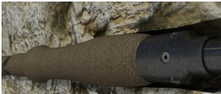
Рисунок 1 – Расширение в скважине полимера системы GeoForm™
