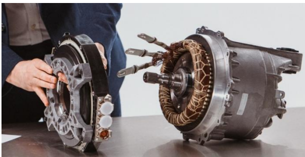
Рисунок 7 – Аксиальный двигатель PHI271R и радиальный двигатель PH382R
