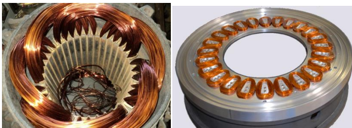
Рисунок 6 – Расположение обмоток радиального и аксиального двигателей
