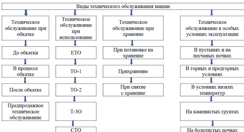
Рисунок 1 – Виды технического обслуживания машин
