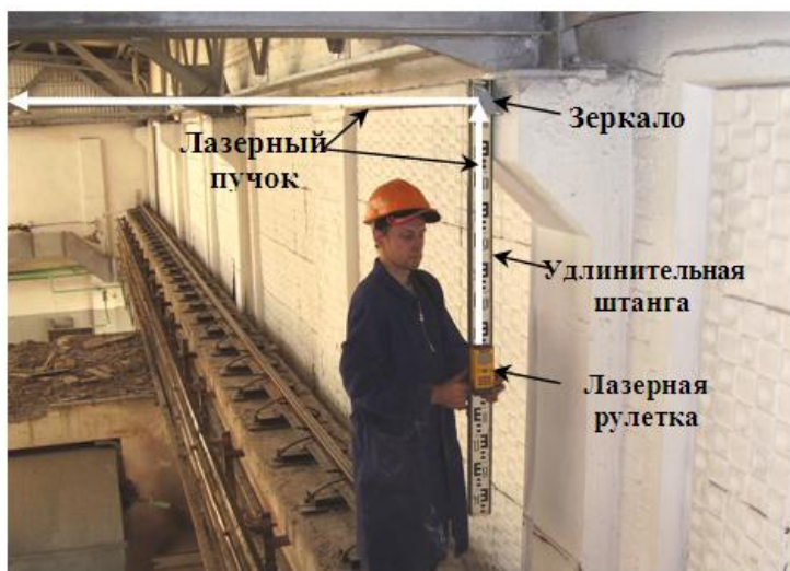
Рисунок 3 – Пример использования ЛЗУ для измерения расстояния между колоннами в пролёте на уровне их оголовка
