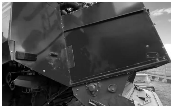
Рисунок 3 – Отремонтированный капот измельчителя КЗС-1218 «Палессе GS-12»
