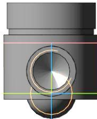
Рисунок 9 – Выходное цилиндрическое отверстие (вид слева)
