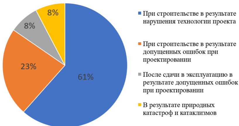
Статистика причин разрушения новых мостов
