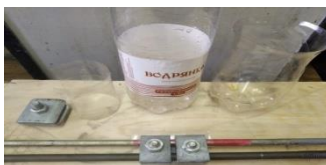
Рисунок 2а. – Материалы для изготовления импульсного промежутка
