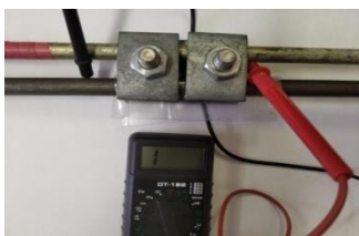
Рисунок 2в. – Импульсный промежуток в сборе
