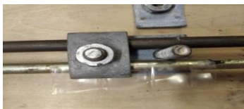
Рисунок 2б. – Промежуточный этап изготовления импульсного промежутка
