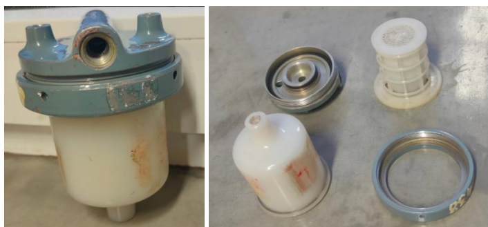
Рисунок 2 – Общий вид и детали фильтра воздушного
