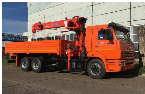
Рисунок 1 – Бортовой грузовой автомобиль с КМУ KS1256G-Птор на шасси КамАЗ-65115
